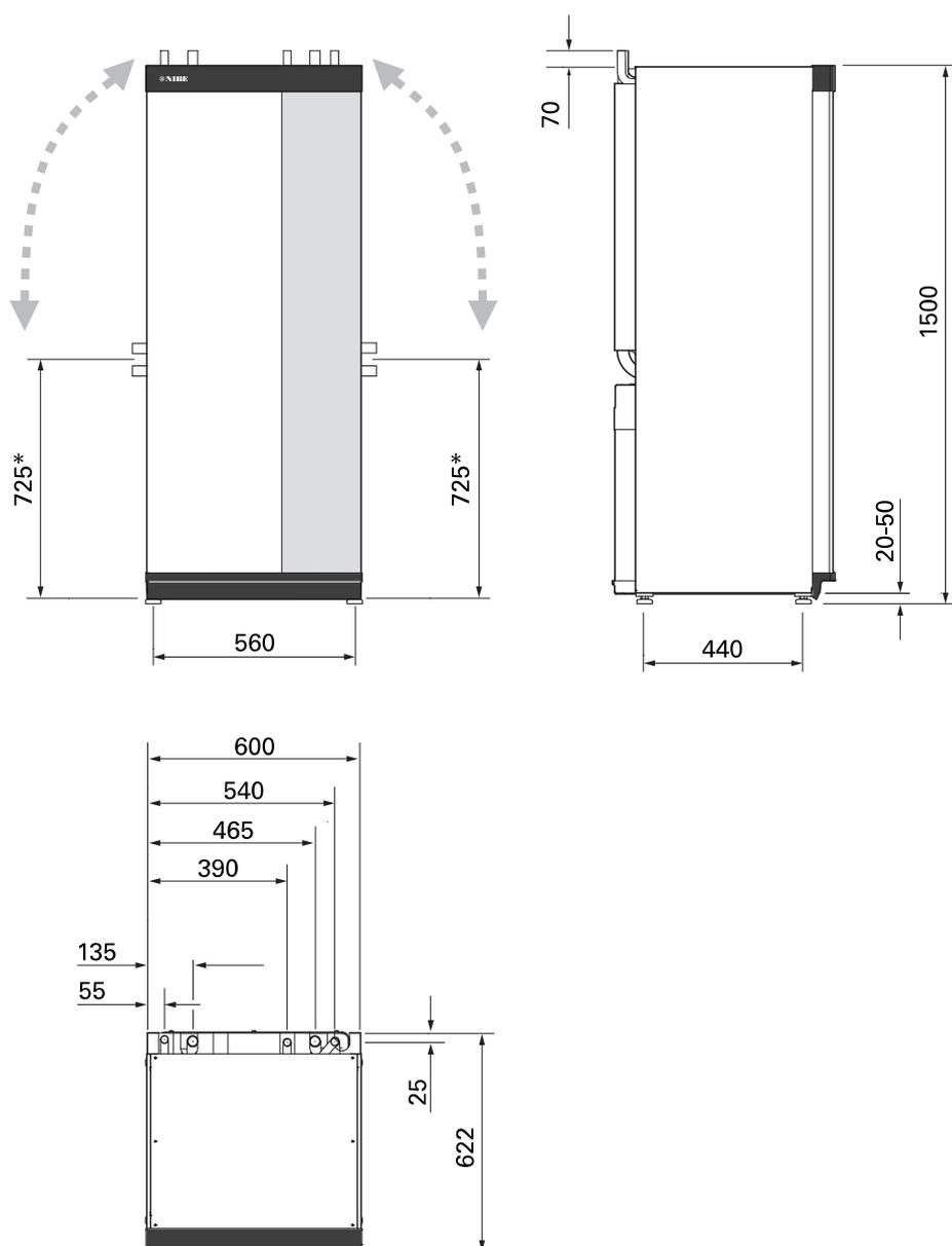
\* Questa dimensione riguarda i tubi del glicole a 90° (attacco laterale). La dimensione può variare di circa  $\pm 100$  mm in verticale, poiché i tubi del glicole sono costituiti in parte da tubi flessibili.
